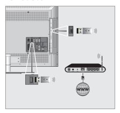
Den Grundig WiFi USB Dongle an die Buchse »USB1« oder »USB2 (HDD)« des Fernsehgerätes anschließen.
